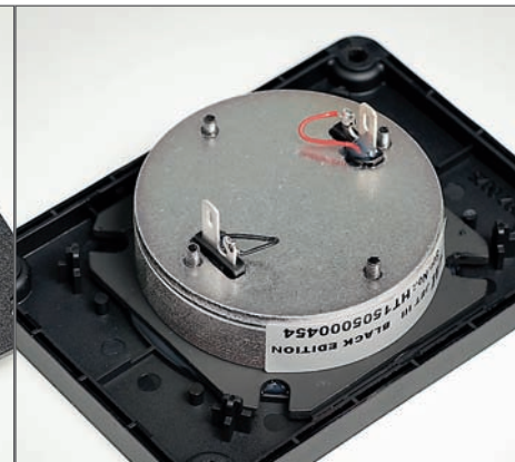
Od tyłu różnicę trudno już stwierdzić. Wszystkie połączenia są na szybkozłączki
