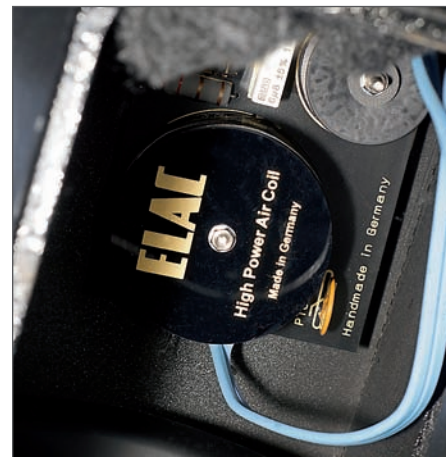
Fragment dolnej gałęzi zwrotnicy (dla dolnego woofera). Cewki powietrzne są dwie. Pokuszono się także o zabezpieczenie przeciwprzebieżeniowe
