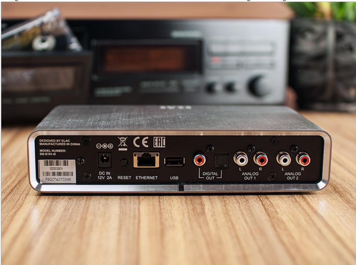
Abschließend ist noch der 2.0 USB-Anschluss zu erwähnen, an dem u.a. externe Massenspeicher angeschlossen werden können. Der Gigabit Ethernet-Port ist für die Integration in das heimische Netzwerk vorgesehen. Damit man den Server sicher auf seine hochwertigen HiFi-Geräte oder Möbelstücke stellen kann, spendierte der Hersteller dem Discovery eine großzügig dimensionierte gummierte Auflagefläche an der Unterseite des Gerätes, für sicheren Stand ist also gesorgt.
